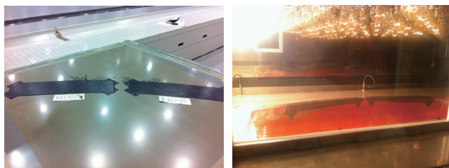
图5 平板预成型体及热隔膜成型过程
